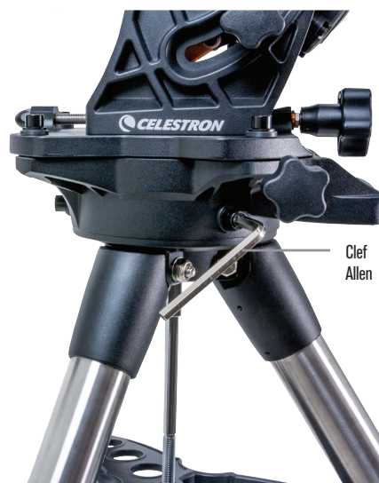
Figure 3 Fixer la monture à votre trépied
