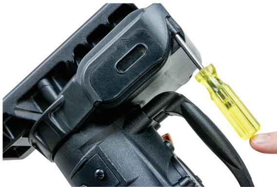
Abbildung 12 Entfernen der Getriebeabdeckung
