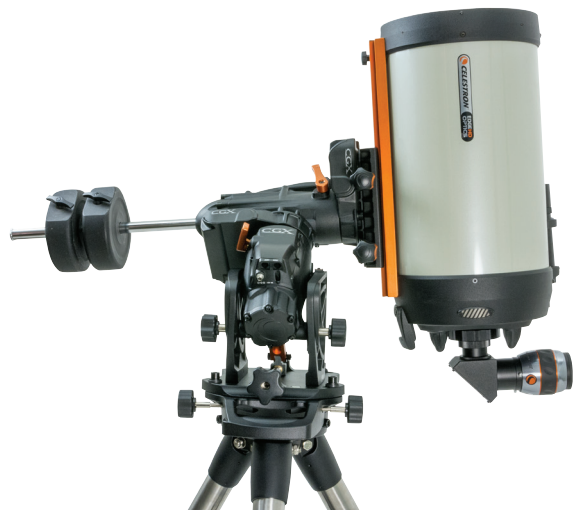
Abbildung 6 Ausbalancieren der Montierung
